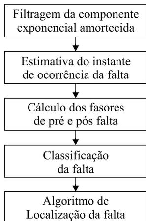
**Figura 1:** Diagrama de blocos da função de localização de faltas.
